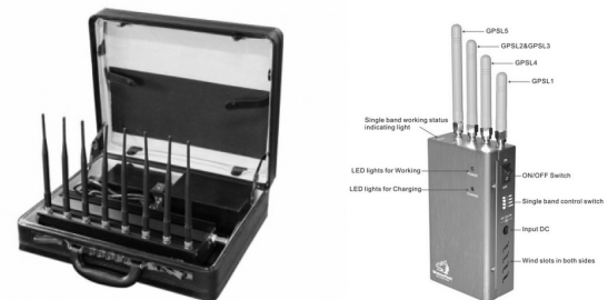
rys. 11 Urządzenia do zagłuszania sygnałów GNSS są obecnie precyzyjnie dopasowane częstotliwością i pasmem do typu wiązki, a nawet sposobu jej kodowania.
