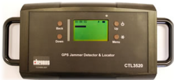
rys. 16 Urządzenie rozpoznające zagłuszanie i wskazujące kierunek źródła
